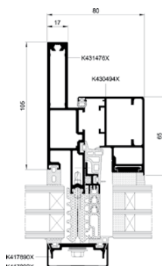
Dwarsdoorsnede van de dorpel met de raam MB-SR50N IW – standaardversie
