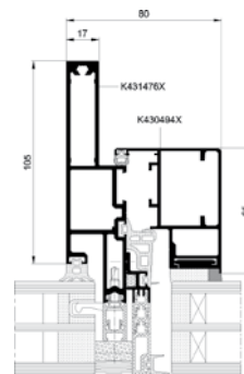
Dwarsdoorsnede van de dorpel met de raam MB-SR50N IW – EFEKT-versie
