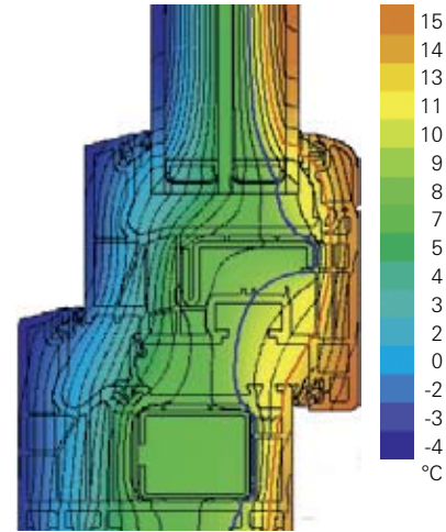
Isothermenverlauf Schüco Corona SI 82 Isothermal flow in Schüco Corona SI 82
