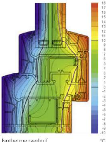
Isothermenverlauf Schüco LivIng mit Anschlagdichtung Isothermal flow in Schüco LivIng with rebate gasket
