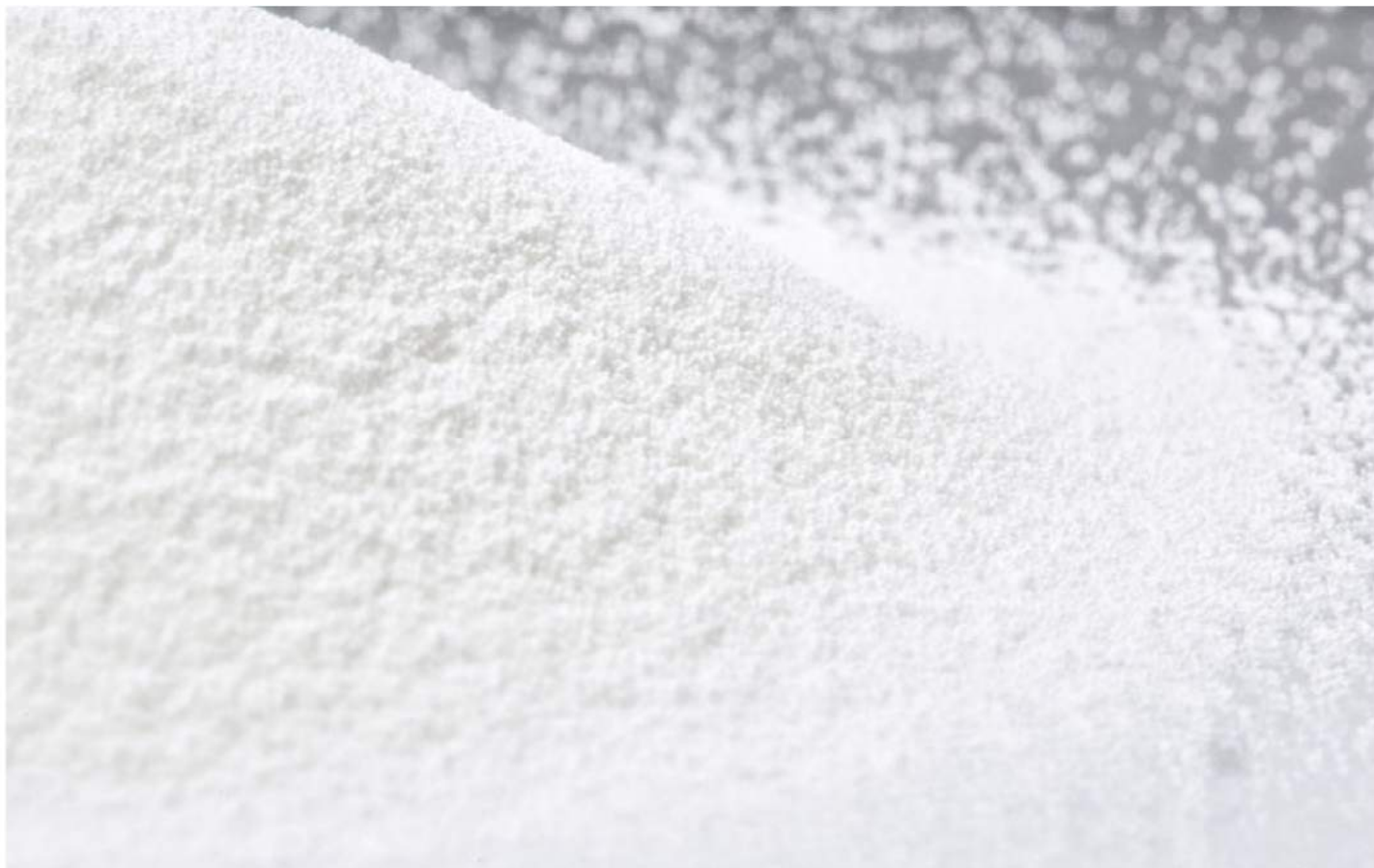
Kunststoff-Granulat als Rohmaterial PVC-U granules as raw material
