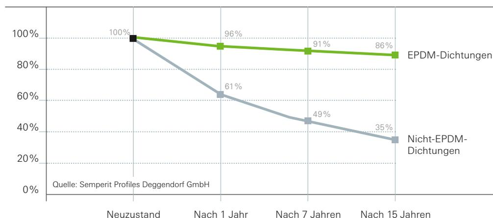
\*Verhalten einer Dichtung bei wiederkehrendem Zusammendrücken, z.B. Öffnen und Schließen des Fensters. Optimal ist eine Rückverformung in die Ausgangskontur. Denn nur diese gewährleistet eine dauerhaft hohe Dichtwirkung.
