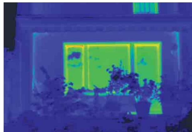
Nach dem sorgfältigen Einbau neuer Schüco Thermo 6 Classic-Energiesparfenster beweist die Thermografie den hohen energetischen Nutzen der Investition. Der ursprüngliche Energieverlust wird nahezu vollständig vermieden.
