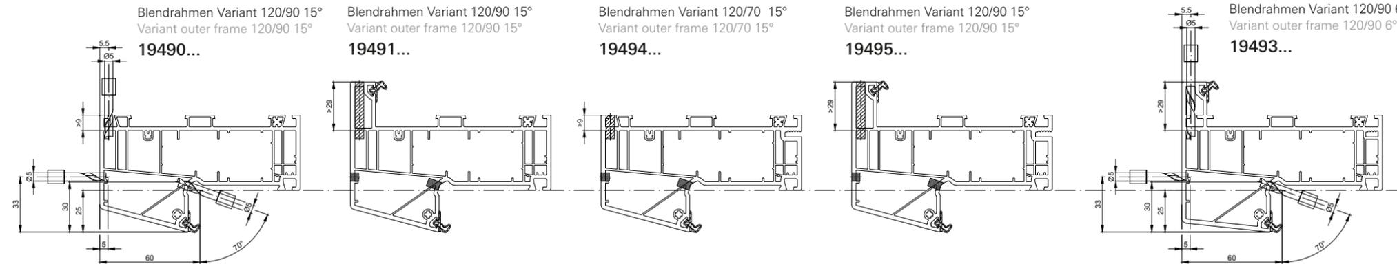
**Entwässerung und Vorkammerbelüftung Blendrahmen Drainage and front chamber ventilation, outer frame**
