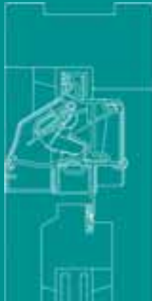
FitStream in houten kozijn; boven buitendraaiend deel
