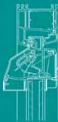
FitStream in kunststof kozijn; plaatsing direct op glas
