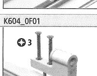
Rahmenbandteil aufsetzen und verschrauben (max. 4 Nm).
