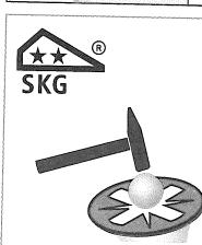
Bei nach außen liegenden Bändern sind die Kreuzschlitze aller Befestigungsschrauben durch Einschlagen von Stahlkugeln zu sichern.
