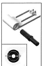
Lagerbolzen mit Markierung auf Mitte (Nullstellung) in das Flügelbandteil einschieben (DIN links/DIN rechts).
