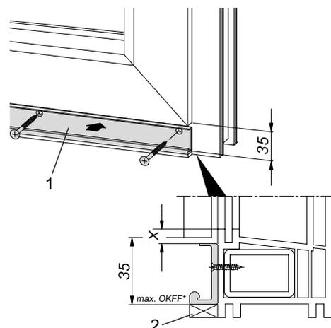
Laufschiene – Einbauzeichnung
