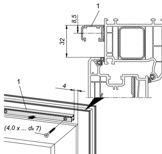
Führungsschiene - Einbauzeichnung
