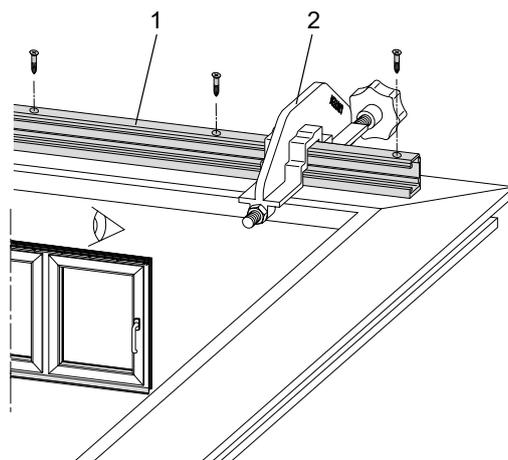
Anschlaghilfe für Führungsschiene
