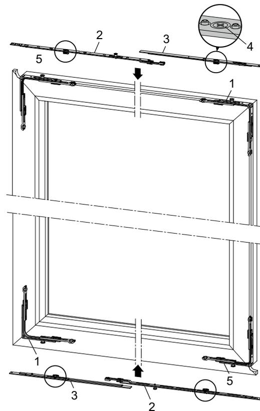
Mittenverriegelung plus Koppellement (waagrecht)
