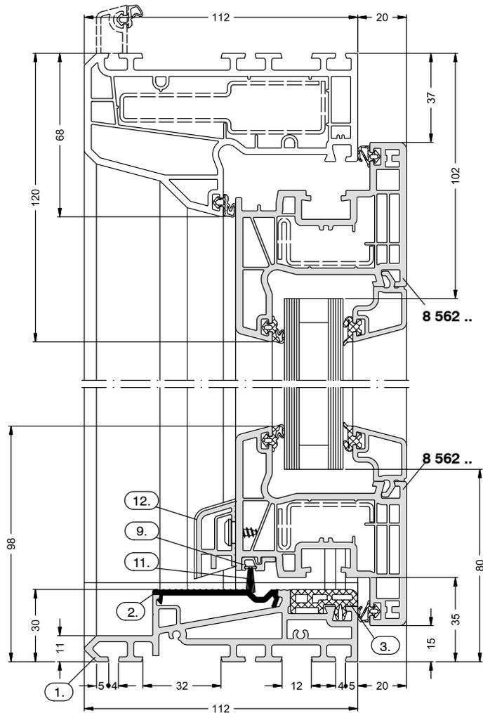
Stulp-Profil 8 636 .. / 8 574 .. – Profilkombination mit Block-Blendrahmen 9 018 .. / Wechselprofil 9 017 ..
